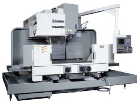
オークマ製 MILLAC 852V ワークサイズ:2050x850x750(mm) 主軸回転速度:6000回転(1/min)
